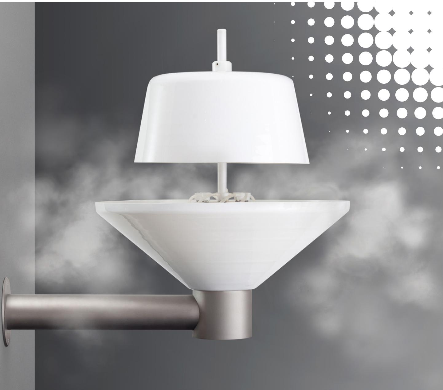
Dispositivo medico progettato per eseguire il trattamento di **nebulizzazione collettiva** in ambiente termale. I componenti principali della nebulizzazione sono l'acqua termale fluente e l'aria compressa: l'acqua viene frantumata in una camera di nebulizzazione ad opera di un getto di aria compressa alla pressione di 3 bar. Questa nebbia umida viene immessa in un ambiente comune, dove il paziente si tratterà per tutta la durata dell'applicazione.
